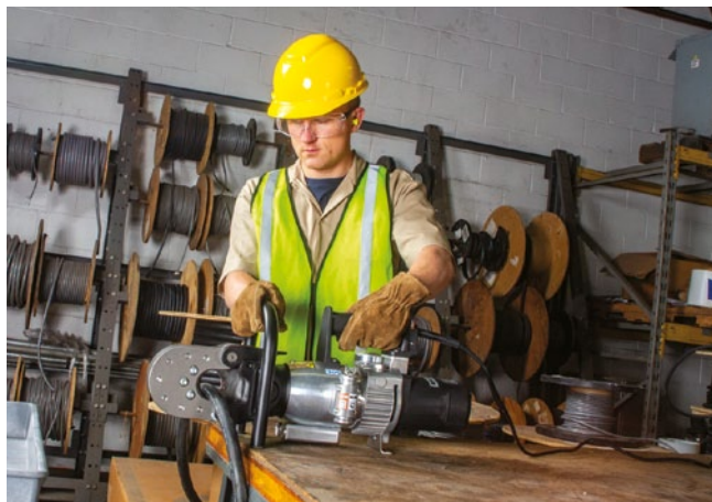
Durchtrennen von Stromkabeln.
